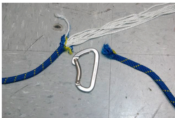
Rep från tester i Black Diamonds lab. Bild: Black Diamond Equipment Ltd.
