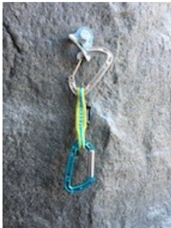
Mekanism 1, bulthängaren fastnar i karbinens näsa
