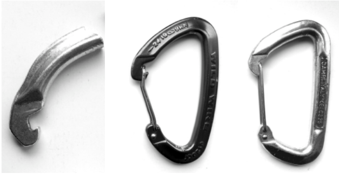
Karbiner med kraftig vinkel vid näsan, som lätt kan fastna i t.ex. bulthängaren
