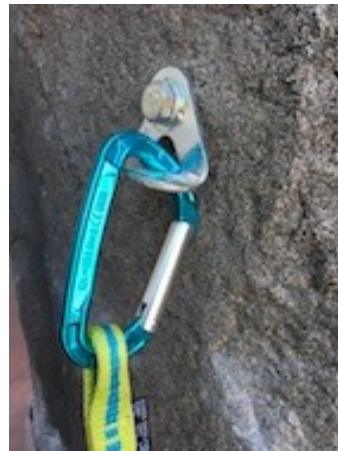
Mekanism 2, karbinen bryts mot väggen med bulthängare och vägg som hävarm
