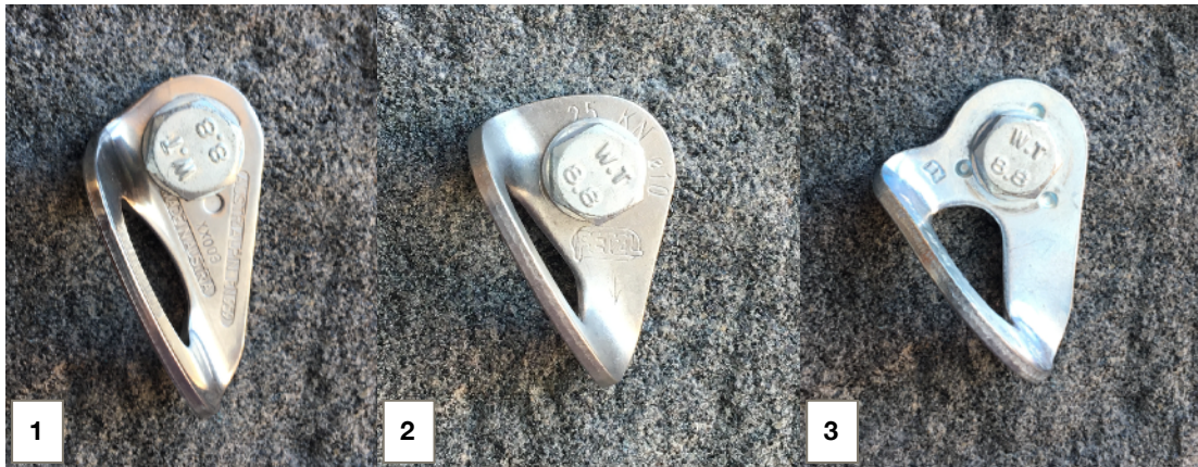
Bulthängare med olika vinklar på bladet/ringen. Ju mer åt horisontellt läget är desto farligare.
