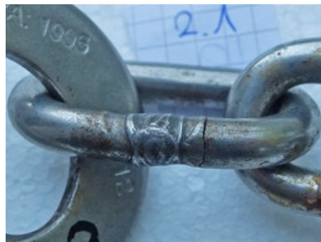
Bild 2: Kättinglänk med spår av korrosion och en betydande spricka invid svetsfog. (foto: DAV)
